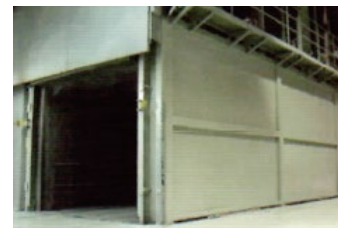
2.5m×2.5m×10mの基材に対応できる大型焼成炉
