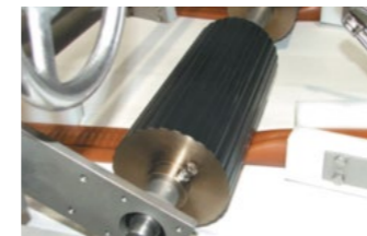
可用辊压方式延展树胶，树胶不会粘辊。
