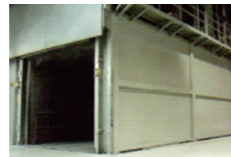
可以用于大尺寸构建的固化炉 最大尺寸2.5m×2.5m×10m
